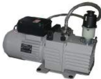
Bomba de vacío
